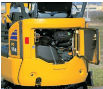
Motorkap: snelle motorcontrole en snelle toegang tot de brandstoftank
