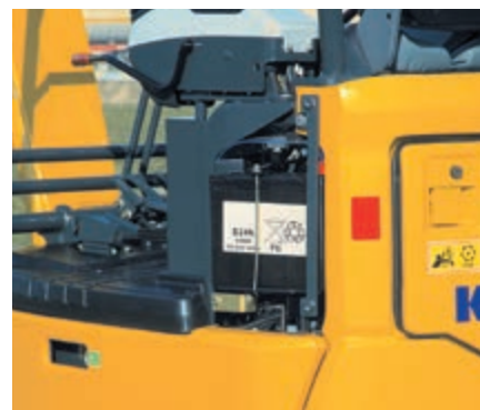
Linker kap: gemakkelijke toegang tot de accu
