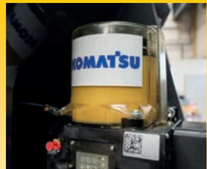
Het in de fabriek gemonteerde automatische smeersysteem beperkt het dagelijkse onderhoudswerk tot een minimum (optie)
