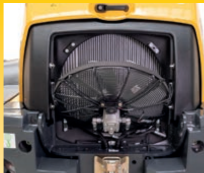
Kantelbare fan biedt gemakkelijke toegang voor het reinigen van de radiator
