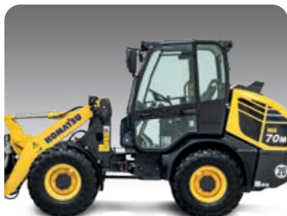
Lage totaalhoogte (2,48 m) voor gemakkelijk transport
